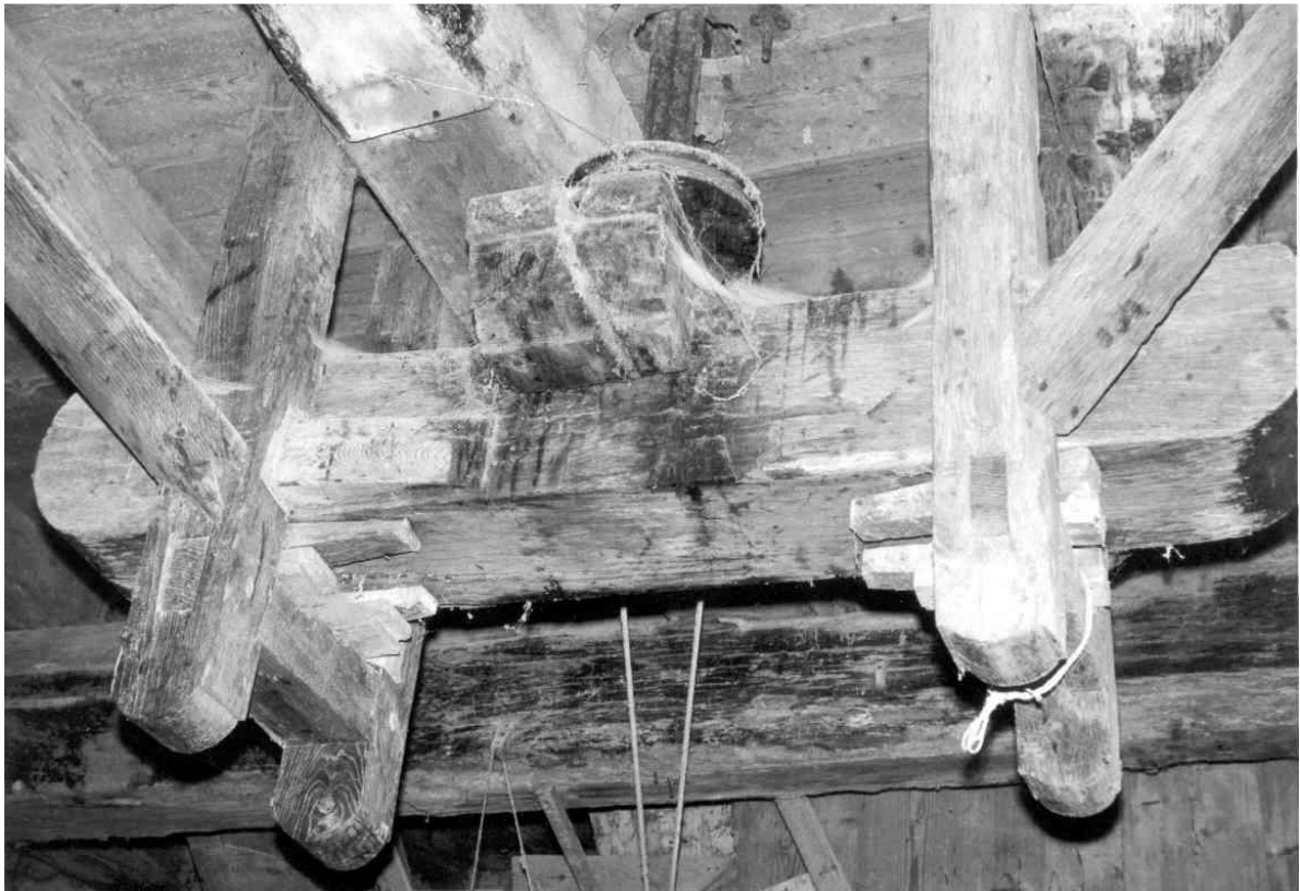
snaarschijf op bolspil voor aandrijving waaier
